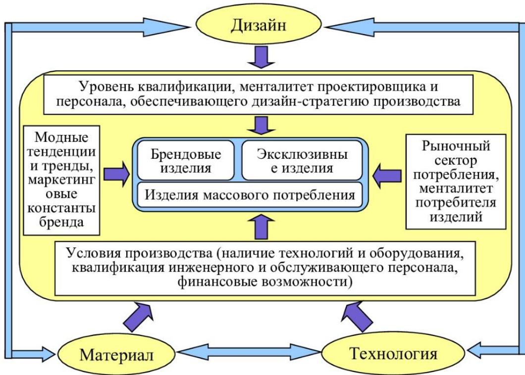
Рис. 4.21. Взаимосвязь дизайна, материалов и технологии изготовления ювелирных изделий с учётом внешних факторов
