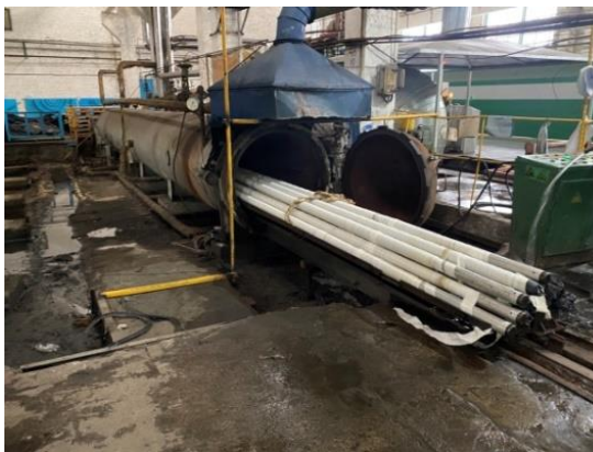
Рисунок 1.5 – Вулканизация рукавов [фотография с завода по изготовлению РТИ ОАО «Курскрезинотехника»].
