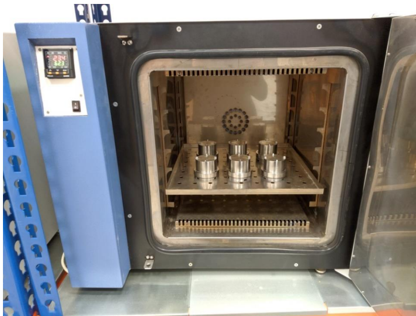
Рисунок 2.6 – Процесс проведения исследования топливопроницаемости ТПУ
