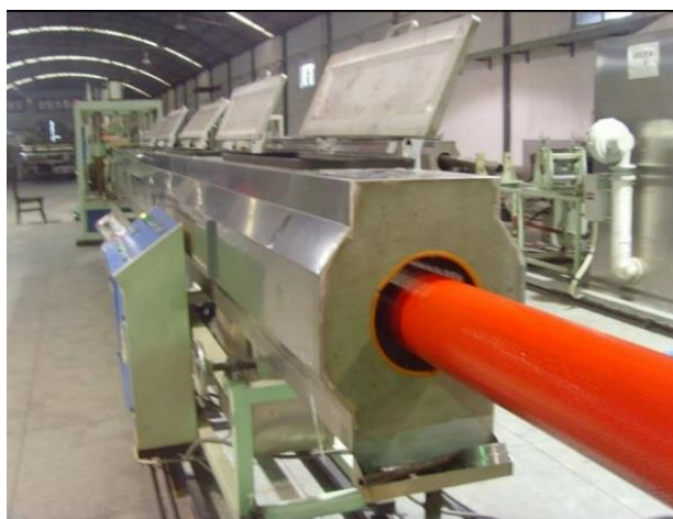
Рисунок 1.9 –Изготовление рукава в экструдере [35]
