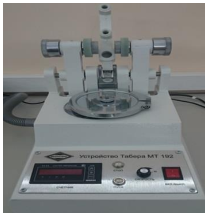
Рисунок 1.16 – Прибор Табера для испытаний устойчивости различных материалов и покрытий к истиранию и износу MT 192
