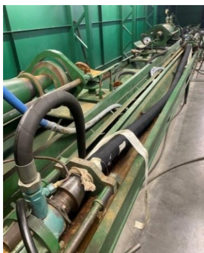
Рисунок 1.6– Испытание напорных рукавов на прочность и герметичность [фотография с завода по изготовлению РТИ ОАО «Курскрезинотехника»].
