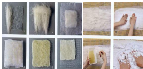
Рисунок 3 – Последовательность процесса формирования нетканого полотна
