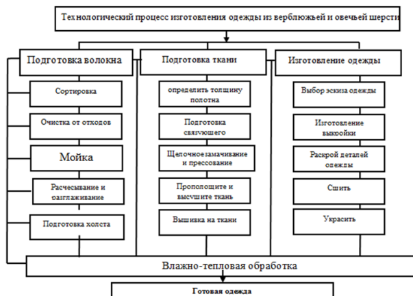
Рисунок 1 – Схема процесса изготовления одежды из нетканого полотна из натуральной шерсти в технике валяния
