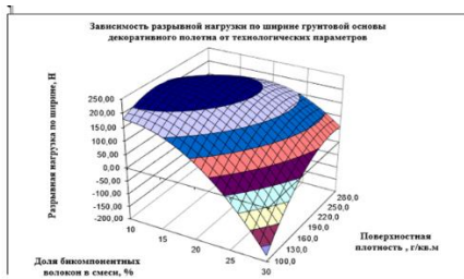
Рисунок 1 – Зависимость разрывной нагрузки по ширине грунтовой основы декоративного полотна от технологических параметров
