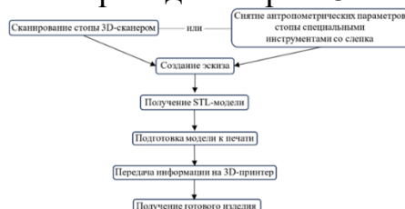
Рисунок 3 – Алгоритм изготовления индивидуальных ортопедических изделий с применением 3D-принтера
