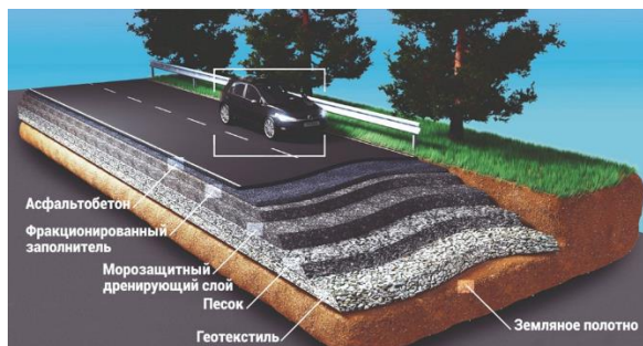
Рисунок 2 – Структура дорожного полотна
