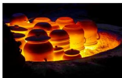
Рисунок 3 – Обжиг керамической посуды в муфельной печи.
