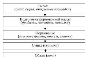
Рисунок 2 – Последовательность операций при производстве керамических изделий
