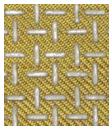
Рисунок 1 – Расположение дискретного покрытия и нитей
