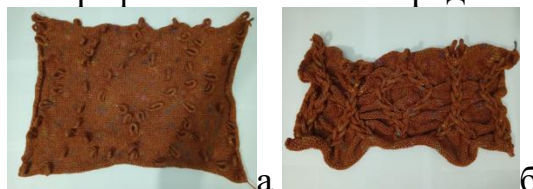
Рисунок 1 – Образец трикотажного полотна без модификации (а) и с модификацией последовательным продеванием петель (б)
