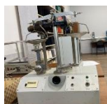
Рисунок 1 – Прибор для определения жесткости и упругости ПЖУ-12м
