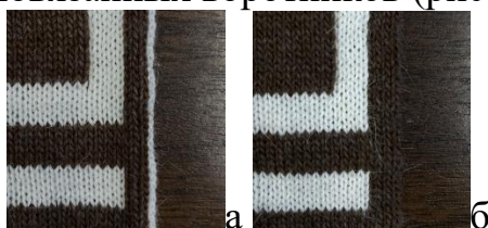
Рисунок 2 – Полученные образцы: а) открытый край; б) закрытый край.
