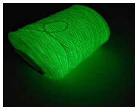
Рисунок 2 – Светящаяся в темноте пряжа, изготовленная с применением инкапсулированного фотолюминесцентного пигмента
