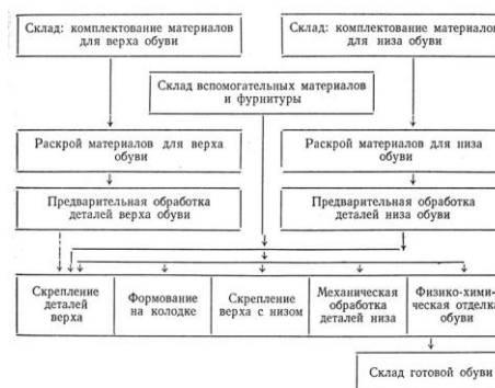
Рисунок 1 – Функциональная схема процесса производства обуви [4]
