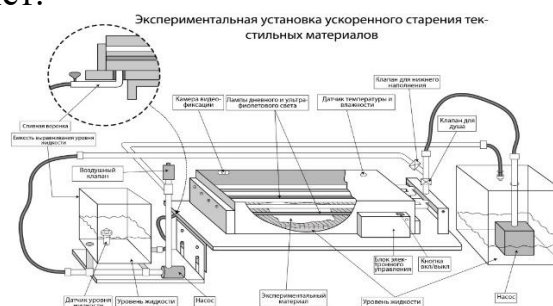
Рисунок 2 – Схема установки ускоренного старения материалов
