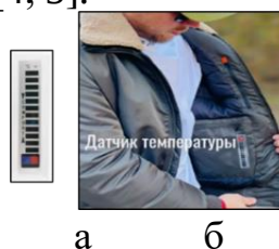
Рисунок 1 – Датчик температуры в одежде: а) выбранная модель датчика температуры, б) пример расположения датчика температуры в одежде
