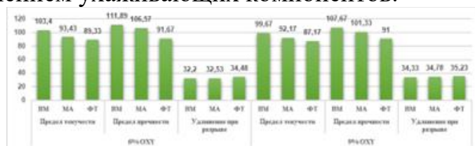
Рисунок 2 – Пределы текучести и прочности при деформации образцов, обработанных составами с ухаживающими добавками.
