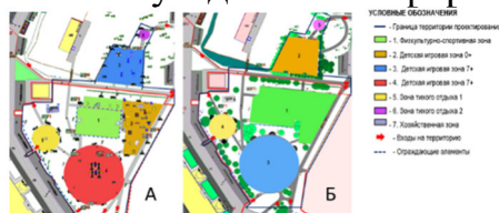
Рисунок 2 – Схема функционального зонирования проектируемой территории: А – существующее положение, Б – проектные предложения
