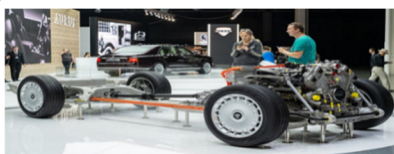
Рисунок 1 – Платформа ЕМП-412311 с мотором и трансмиссией
