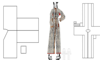
Рисунок 2 – Схема базовой конструкции чертежа на основе упрощения цельнокроенного плечевого изделия (слева); художественный эскиз модели пальто (центр); схема чертежа пальто (справа)
