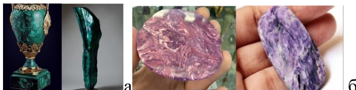
Рисунок 4 – а) ваза из малахита (слева), ваза из литьевого камня (справа); б) литьевого камень (слева), натуральный чароит (справа)
