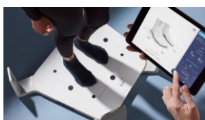
Рисунок 2 – Сканирование стоп и получение их 3D-модели с помощью технологии Intel RealSense
