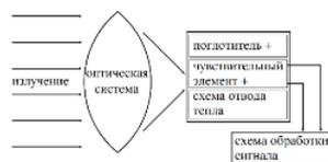
Рисунок 1 – Компонентная схема болометрического приемника излучения
